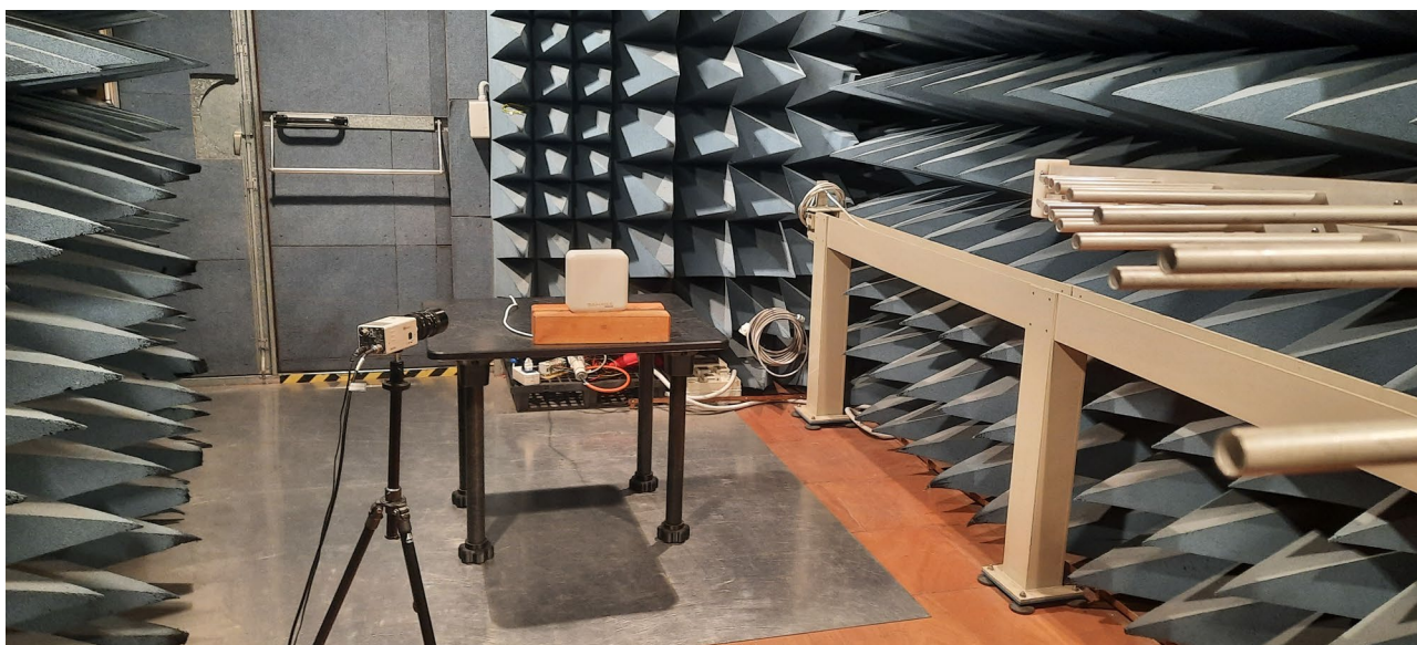
Foto 6 Prova di immunità irradiata con antenna biconica-log. periodica in polarizzazione orizzontale.
