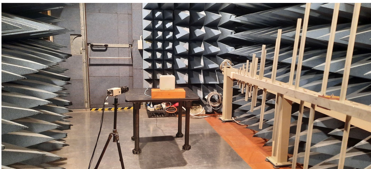
Foto 5 Prova di immunità irradiata con antenna biconica-log. periodica in polarizzazione verticale.
