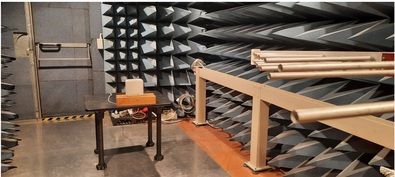
Foto 3 Prova di emissione irradiata con antenna biconica-log. periodica in polarizzazione orizzontale.
