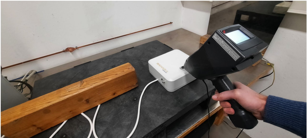
Foto 4 Prova di immunità alle scariche elettrostatiche.
